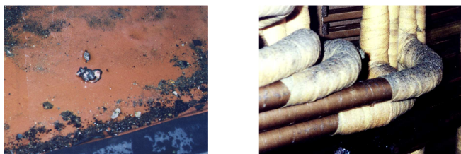
Рис.3 Шлам в трансформаторе (а – на активной части, б – на обмотках)
