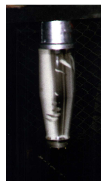
Рис.4 Образование углеродистого осадка на поверхности ввода (а - место горения дуги в зоне транспортного болта; б - науглероженная поверхность фарфора ввода, расположенного над местом горения дуги).
