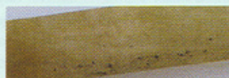
Рис. 6. Следы частичных разрядов в бумажно-масляной изоляции
