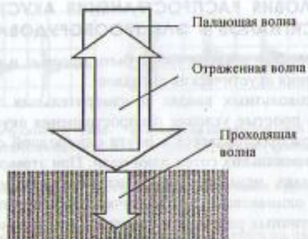
Рис. 13 Прохождение акустической волны через плоскую границу двух сред
