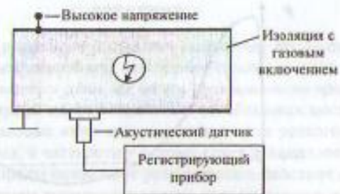
Рис. 2. Акустический контроль частичных разрядов во внутренней изоляции электроаппарата
